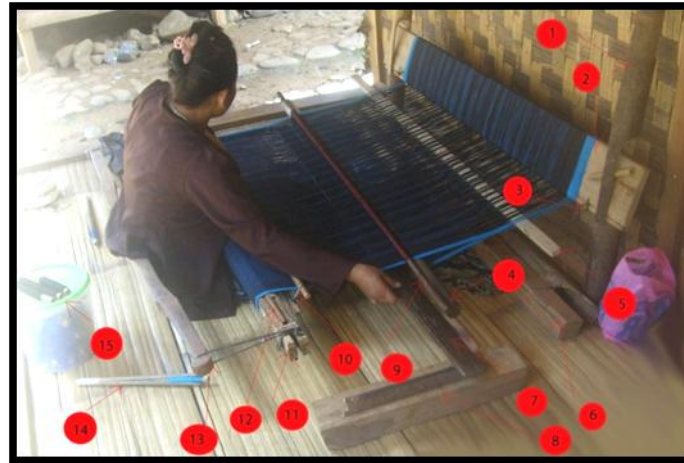
Gambar 1. Alat tenun / pakara tinun . Sumber: Dokumen pribadi.2010. Keterangan Gambar:1)Cancangan, 2)Totogan, 3)Pangrambuan, 4)Limbuhan, 5)Patitihan, 6)Kekedal, 7)Barera, 8)Rorogan, 9)Jinjingan, 10)Sisir, 11) hapit, 12) pangrerean, 13) cawor, 14)toropong, 15) pajal
